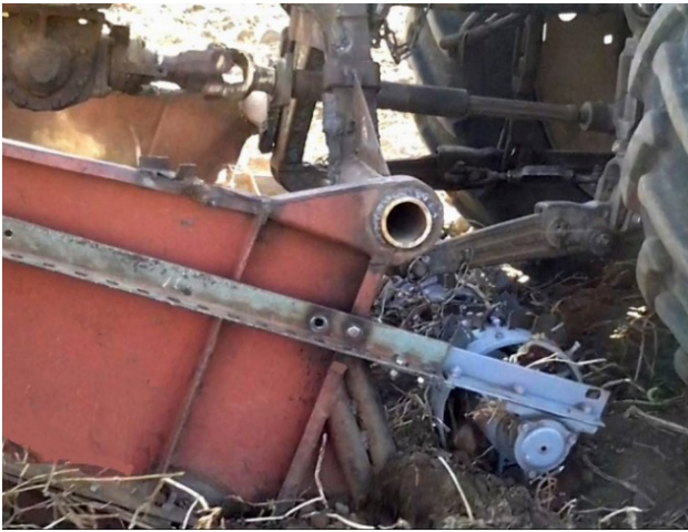
Նկ. 3. Գիտափորձնական հետազոտությունների ժամանակ կիրառված կարտոֆիլահանի ռոտորային կոշտամանրիչ:
