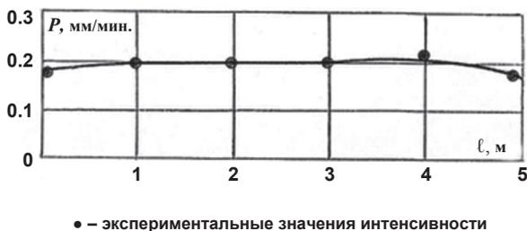
Рис. 5. График изменения интенсивности дождя в дождемерах в зависимости от их удаления от стояка дождевального устройства (составлен автором).
