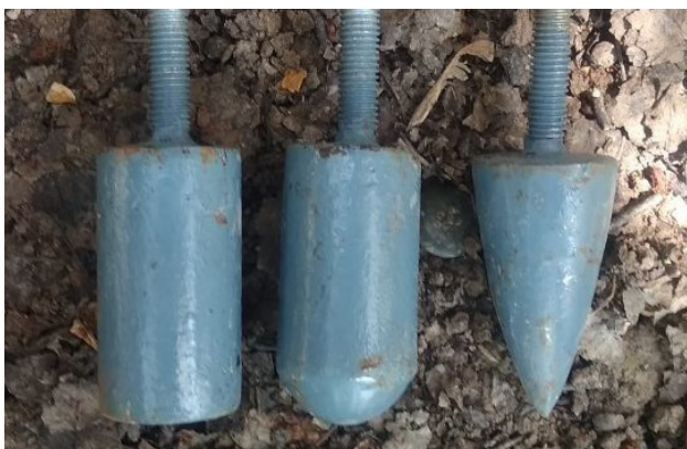
Սկ. 2. Կարտոֆիլահանի կոշտամանրիչի փորձարկվող մատներ (Ա.Պ. Թարվերդյան և ուրիշ., 2020):
