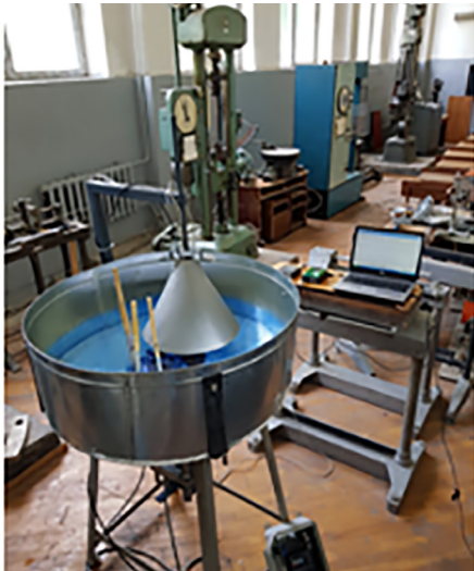
Նկ. 2. Ջրային միջավայրում բույսերի վիբրացիոն կտրման փորձարարական կայանքի ընդհանուր տեսքը:
