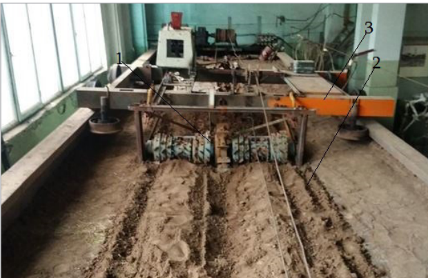
Նկ. 2. Ռոտորային կոշտամանրիչի աշխատանքը լաբորատոր գիտափորձի ժամանակ. 1 - ռոտորային կոշտամանրիչ, 2 - հողային խրամատ, 3 - կառավարվող սայլակ:
