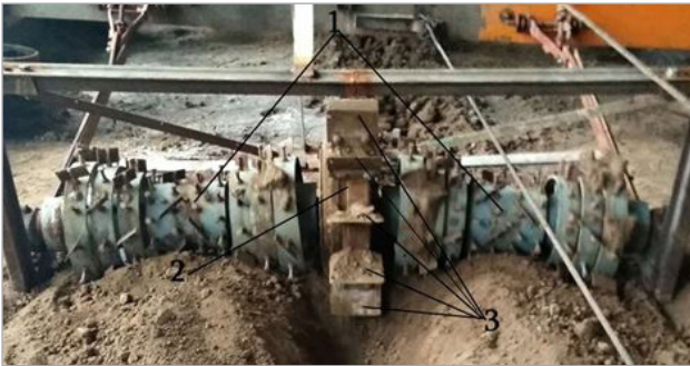
Նկ. 1. Շարժաբեր թմբուկով ռոտորային կոշտամանրիչի ընդհանուր տեսքը. 1 - բասող օրգան, 2 - հողակառչիչավոր թմբուկ, 3 - հողակառչիչ:
